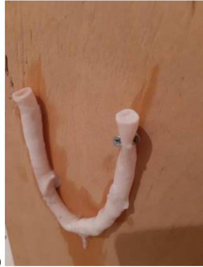
Рис. 7. Кусок артерии быка, закрепленный на панели из фанеры двумя различными способами. За счет прилипания (слева) и за счет частичного обжаривания двумя саморезами (справа)
