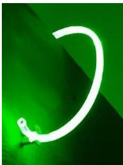
Рис. 11. Силиконовая трубка диаметром 3,5 мм, внутрь которой направлялся луч от лазерного источника через фокусирующий конус, светилась с тыльной стороны фанерного щита. Причем, свет распространялся, судя по изображению, исключительно внутри стенок трубки
