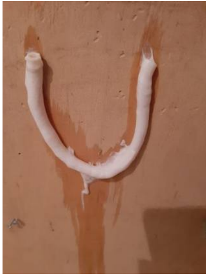
Рис. 7. Кусок артерии быка, закрепленный на панели из фанеры двумя различными способами. За счет прилипания (слева) и за счет частичного обжаривания двумя саморезами (справа)
