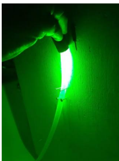
Рис. 10. Свет от лазерного источника, проходящий через толстую силиконов трубку диаметром 11 мм, при освещении ее торца лазером без направляющего конуса (слева) и с направляющим конусом (справа)
