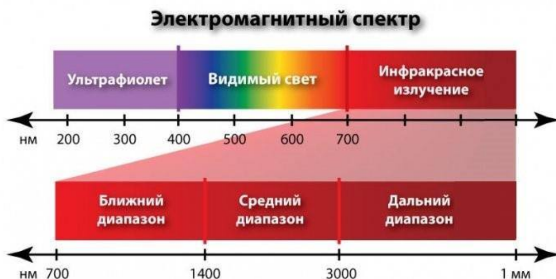
Рис. 1. Электромагнитный спектр, в котором красный свет занимает диапазон от 600 до 700 нм
