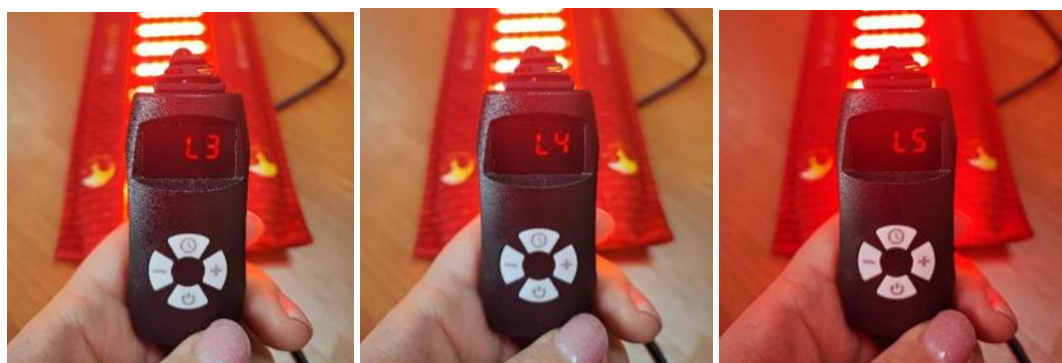
Рис. 8. Три мощных (горячих) режима нагрева: L3 – L5
