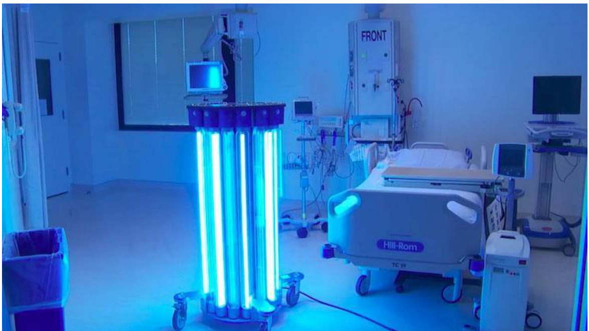
Рис. 3. Лампы УФ-излучения, которые используются для дезинфекции помещений
