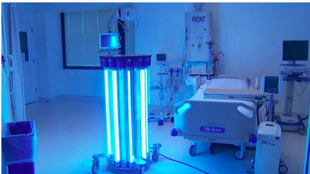
Рис. 3. Лампы УФ-излучения, которые используются для дезинфекции помещений
