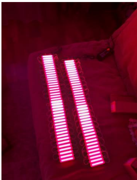
Рис. 8. Пояс производства «Монолит Текнолоджи» со светодиодами с рассеивателями (Китай)
