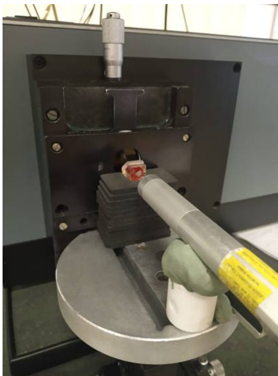
Рис. 28. Эксперимент с пропусканием луча «зеленого» лазера через каплю крови в кювете
